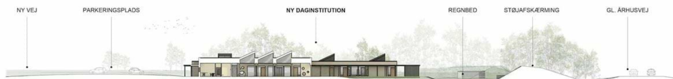
Landskabssnittet viser principper for støjskærmning, regnvandsbed og bebyggelsens beliggenhed i landskabet
